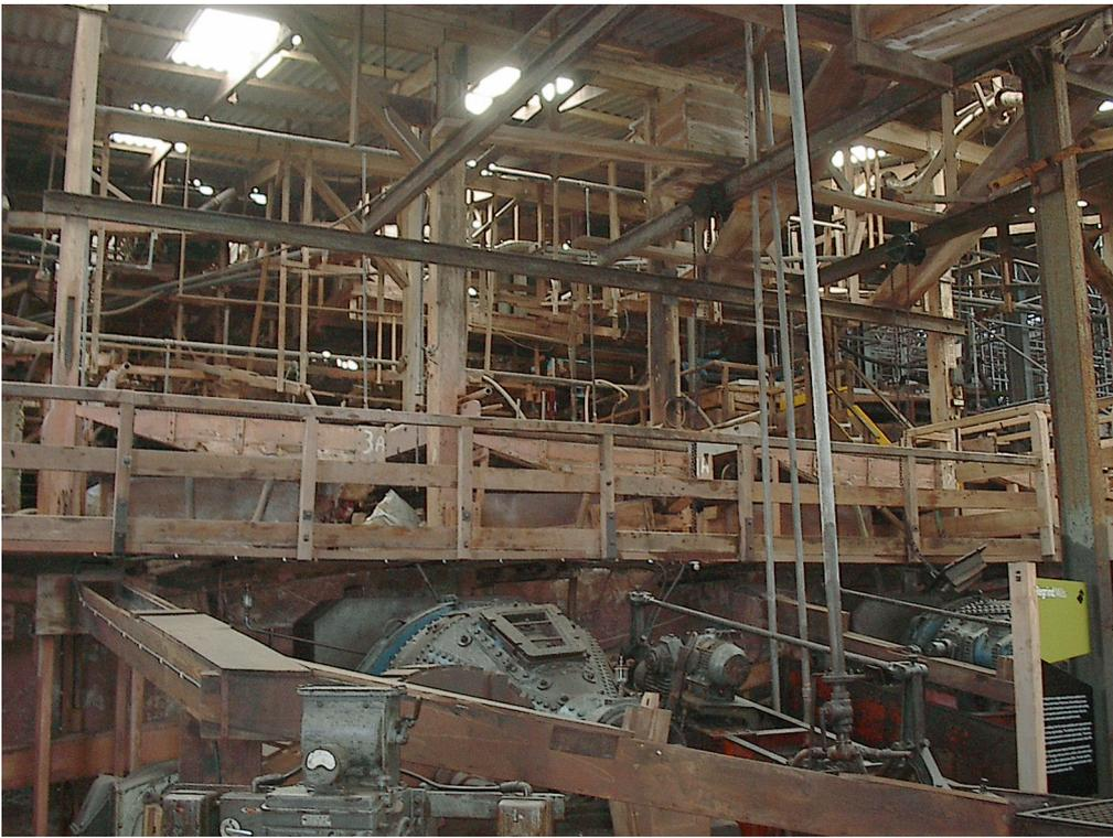
Das ist die eine Seite der riesigen Reinigungsanlage. Kugelmühlen zerkleinern das Erz. Magnete holen Eisenerze heraus. Im Nassverfahren wird über die Hälfte des tauben Gesteins entfernt, und dann läuft der Schlamm über unzählige Rüttelrinnen. Beim Trocknen wird
