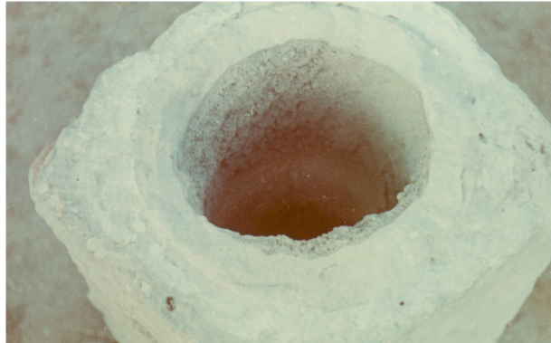
Kesselstein in den römischen Wasserleitungen
